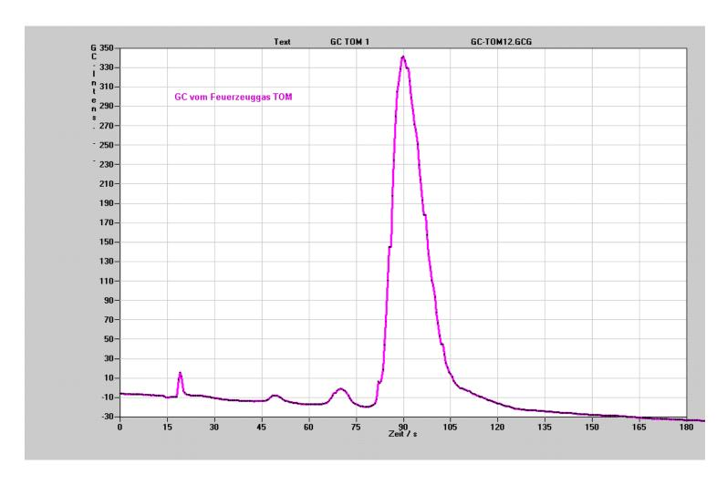
2.2.3 Zusammensetzung des Flüssiggases <u>CFH</u>: Propan, (i-Butan), n-Butan (22.2.2013)
