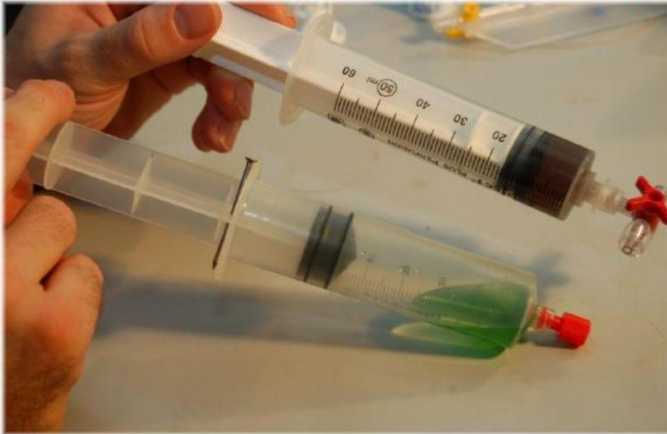
In eine Spritze mit durchbohrtem Stempel füllt man 20 mL mit Indikator versetztes Wasser – aus einer weiteren Spritze lässt man durch die Lösung  $\text{CO}_2$  sprudeln, bis die Farbe des Indikators umschlägt.
