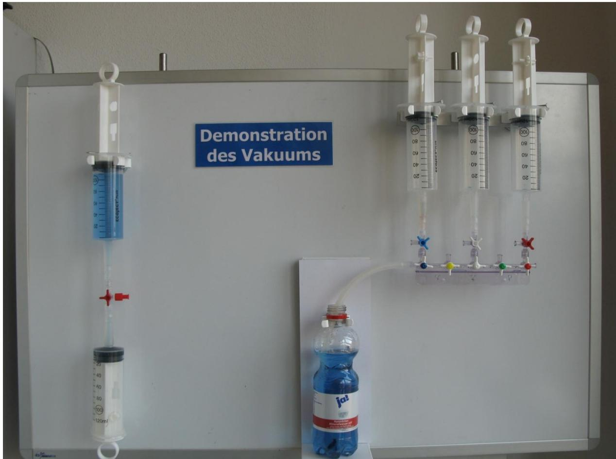
(1) Demonstration des Vakuums mit angefärbtem Wasser
