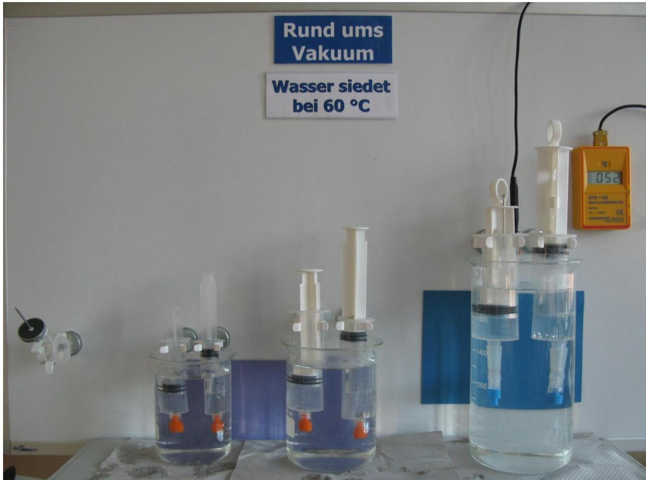
Die Experimente lassen sich in unterschiedlichen Spritzen durchführen: 20 mL, 60 mL, 120 mL
