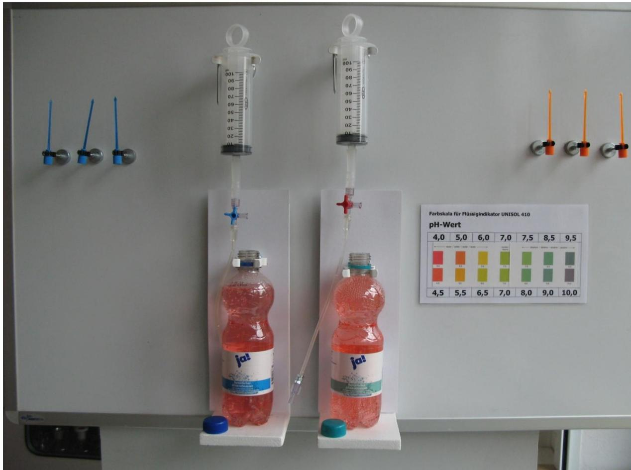
Bereits beim Ansaugen des Mineralwassers entweicht bereits Kohlenstoffdioxid(g): aus je 20 mL Mineralwasser der Sorte „classic“ ca. 20 mL CO<sub>2</sub>(g), der Sorte „medium“ ca. 10 mL Gas.
